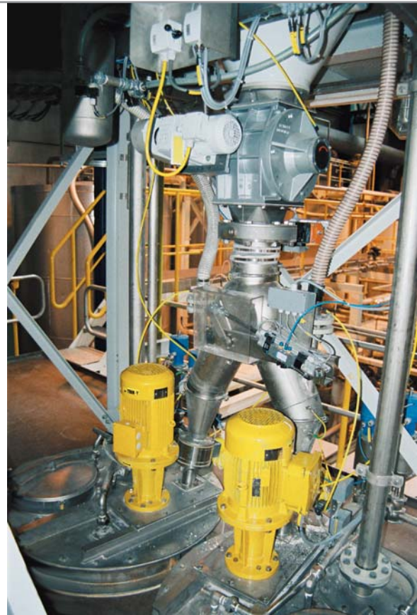
YTRON-Y ByPass en el sector cervecero Aplicación: Suspensión de tierra de Diatomeas, inertización con CO 2 para descarga continua de producto
