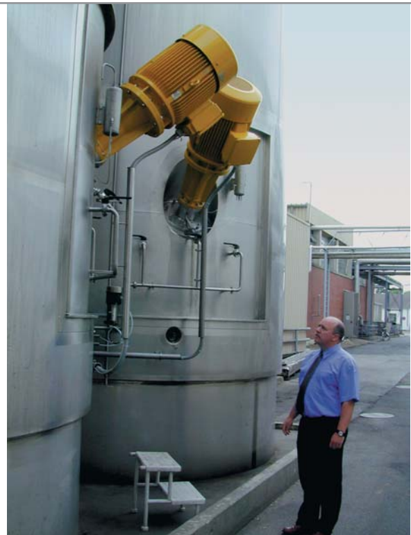
YTRON -Y en versión de brida del tanque, montaje por debajo del nivel del líquido Aplicación: Leche fermentada (100.000 l)
