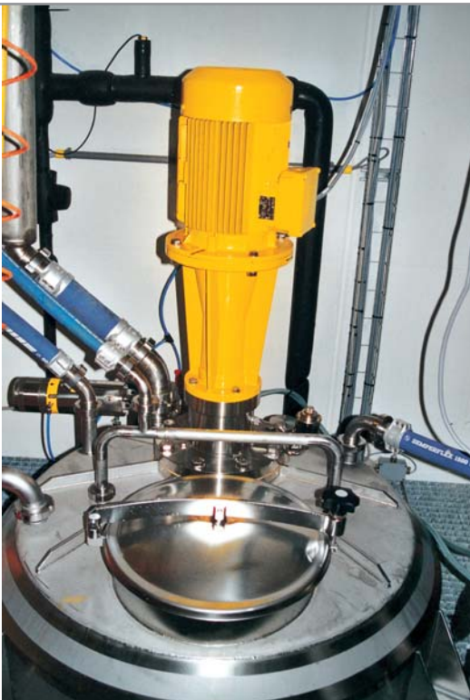
YTRON -Y HS en versión de brida del tanque Aplicación: Suspensión de compuestos espesantes
