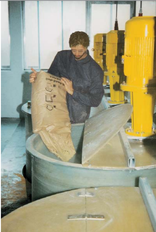
YTRON -Y en depósito mezclador abierto Aplicación: Esmaltes cerámicos
